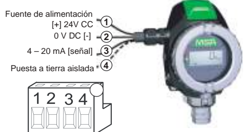
Conexión de 3 hilos del PrimaX P
