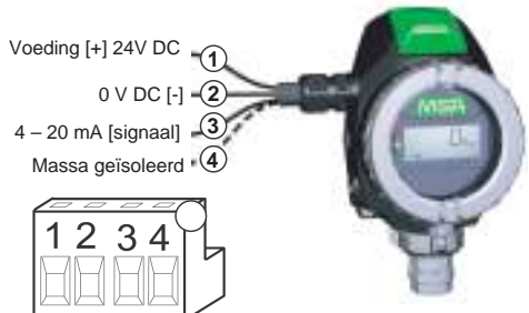
3-draadsverbinding - PrimaX P
